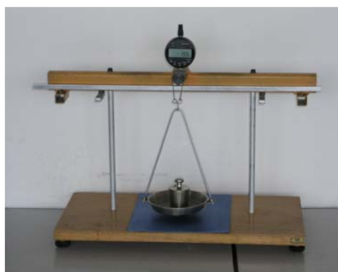
Obr. 1 Měření modulu pružnosti z průhybu tyče
