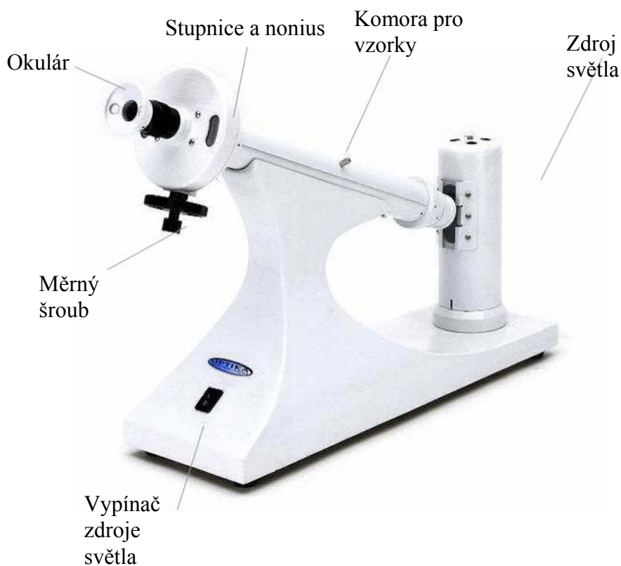
Obr. 4 Kruhový polarimetr PL-1
