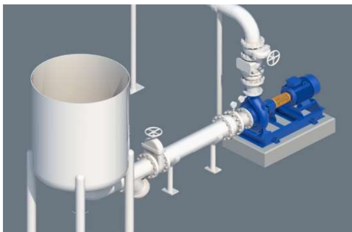
Obr. 8 Čerpadlo v nátokové dispozici [4]
