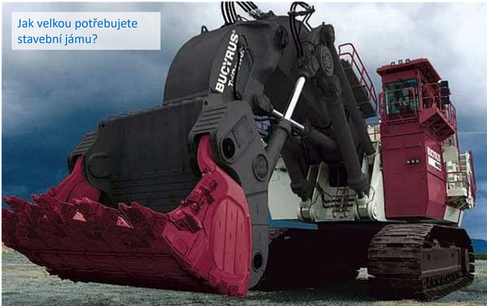
Obr. 67.: Největší bagr na světě Bucyrus RH400 4400 hp (2 x 16ti válec), 889 t, objem lžíce 45 m 3
