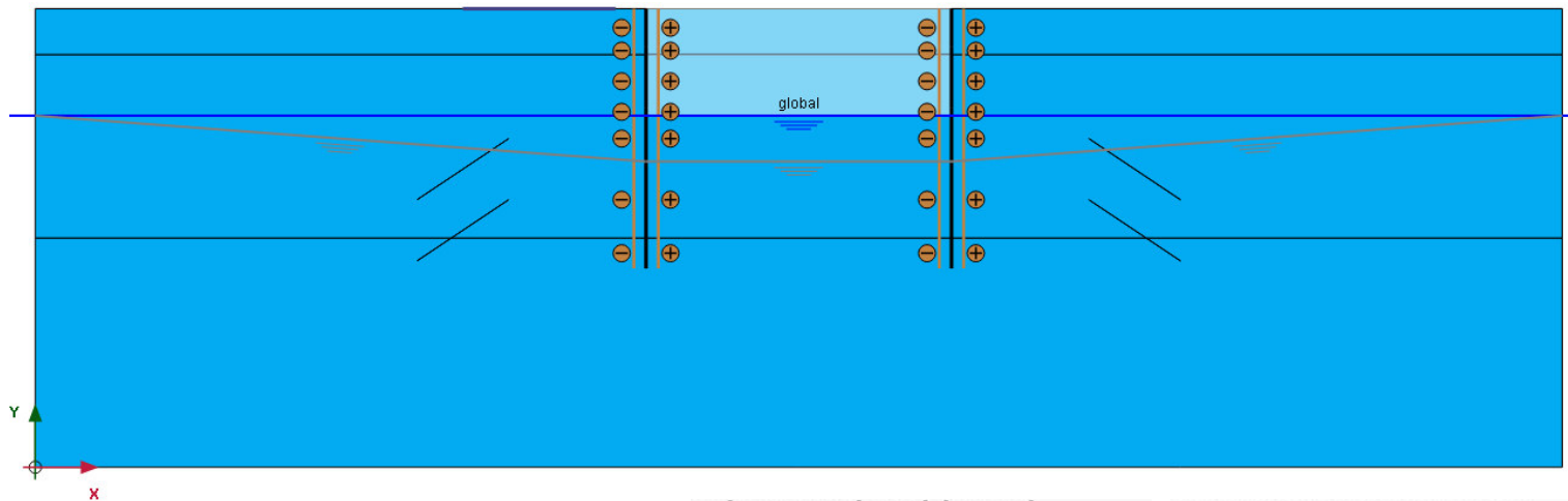
Obr. 50.: Fáze výpočtu 6 – druhé kotvení Původní globální HPV
