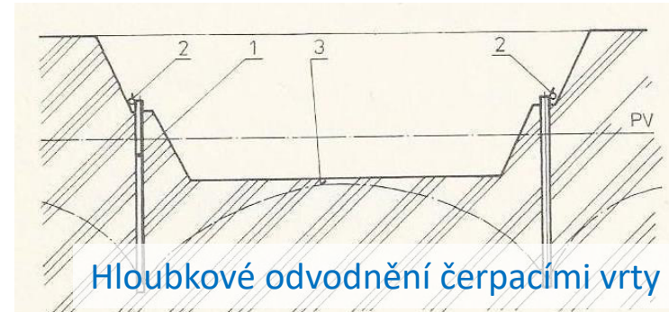
Hlubkové odvodnění stavební jámy
